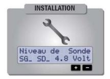
Le BLUNIK II permet l'utilisation de sondes de proximité inductives à 2 ou 3 câbles. Avec ce paramètre vous pouvez adapter le **voltage de détection** des différents types de sonde avec notre dispositif.
