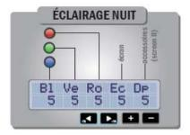
Grâce à cette option, vous pouvez régler l'intensité lumineuse des 3 LED du «feu tricolore», ainsi que celle de l'écran du BLUNIK II et les écrans des différents accessoires en mode nocturne.
