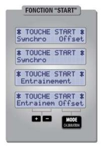
Ce paramètre vous permet de régler l'action du bouton **START** sur le BLUNIK II, dans la procédure de Départ.
