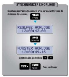
d'une légère Dans le cas différence (dixième de seconde), revenir dans l'écran REGLAGE DE L'HORLOGE et appuyez sur le bouton MODE pour passer dans le mode "AJUSTER HORLOGE". Ensuite avec les boutons + o - ajustez dixième par dixième différence que vous avez par à l'horloge de rapport référence. Une fois ajustée, pour sortir du mode pressez ENTER.
