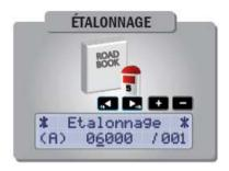
L'étalonnage du BLUNIK II sert a adapter la mesure de distance a la mesure proposée par l'organisateur du Rallye qui correspond pas nécessairement a un distance réelle.
