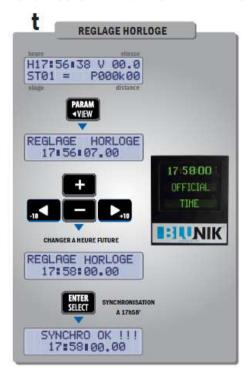
Pour régler horloge du BLUNIK II entrez l'heure exacte (heure. minutes et secondes) à laquelle souhaitez VOUS synchroniser, à l'horloge de référence. Lorsque aue l'horloge de référence affiche l'heure souhaitée, appuvez sur le bouton **ENTER**. L'horloge est maintenant
