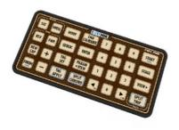
Permite agilizar la programación antes de iniciar el tramo (también durante el tramo) ya que dispone de los 10 dígitos y las teclas para validar datos y cambiar de vista.
