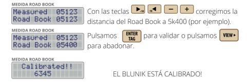
Nota: El proceso de calibración es el mismo si usas sondas que si usas medición por satélite con INTELLIGENT ANTENA
