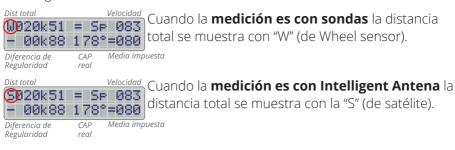
La medición interna con sondas es al metro, la medición con Intelligent Antena es al decámetro.
