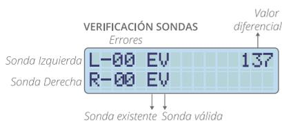
Para verificar el perfecto funcionamiento de las sondas entramos en la pantalla de Calibración y a continuación pulsamos
